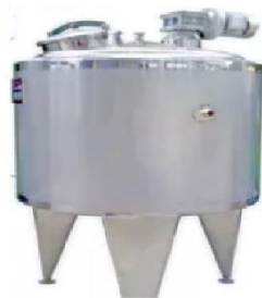
Figura. 2.3 Tanque para la fermentación de 4100 litros con enchaquetamiento.
