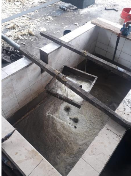
Figura. 1.6 Tanque para la fermentación artesanal (cortesía de la planta artesanal)
