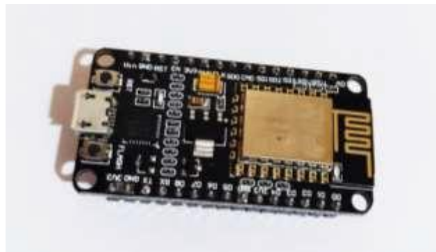
Figura 3.2 Tarjeta NodeMCU v3- ESP8266
