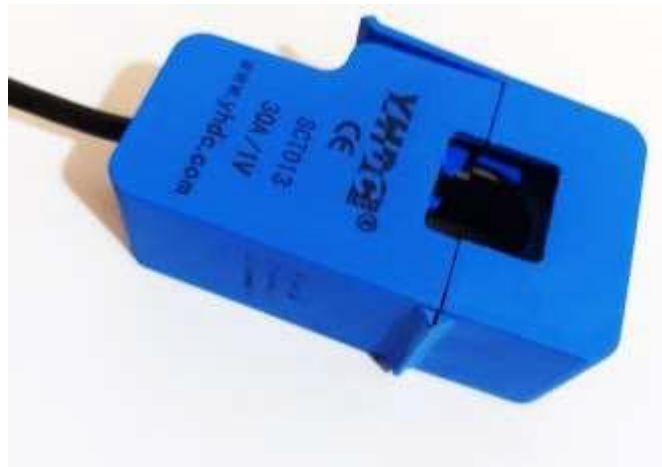
Figura 3.3 Sensor de corriente no invasivo 30A/1V - SCT-013-030
