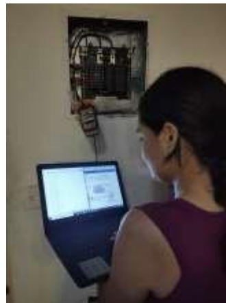
Figura 3.8 Prueba del sensor de corriente
