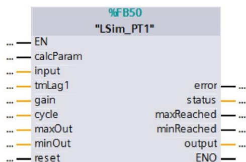
Figura 2-9 Bloque de Función LSim_PT1 (Siemens, 2017)
