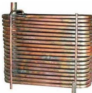
Figura 2. 6: Evaporador de tubo. [10]
