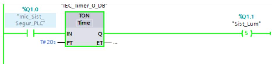
Figura 3. 16. Activación del sistema lumínico
