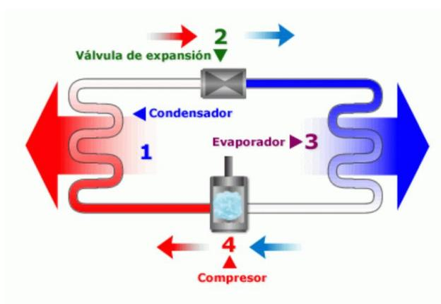
Figura 2. 1 Sistema Básico de Refrigeración. [3]
