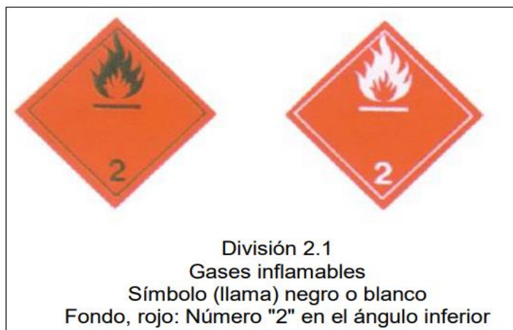
Figura 2.4 División de gases inflamables en la clasificación IMO. Pictograma
