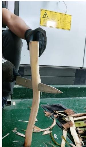
**Figura 2.4 Proceso de corte del raquis para obtener la fibra**
