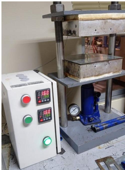
**Figura 2.12 Prensa hidráulica empleada para la obtención de láminas**
