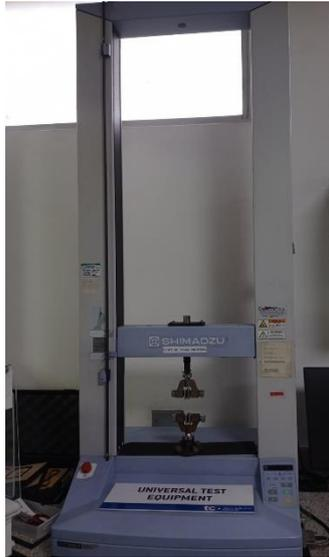
**Figura 2.15 Equipo de ensayo universal marca Shimadzu**
