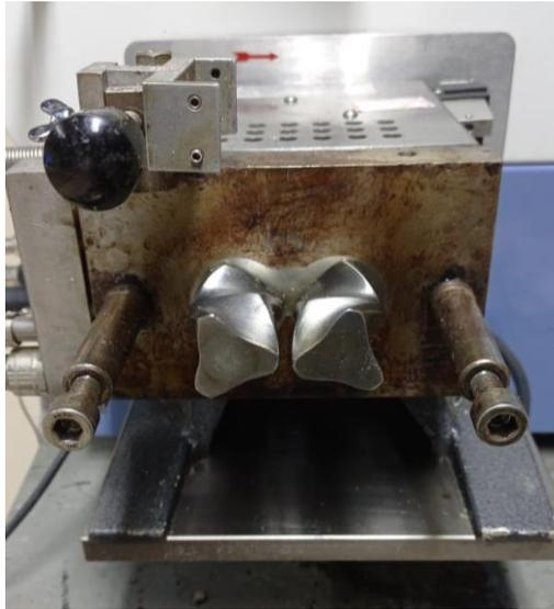
**Figura 2.10 Mezcladora de doble tornillo marca Brabender**
