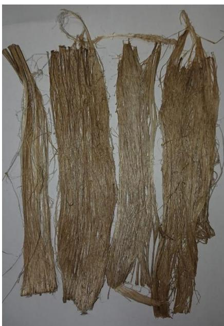
**Figura 2.6 Fibra de raquis de banana posterior al proceso de secado**
