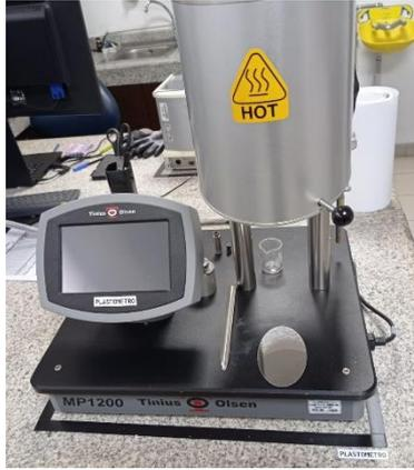
**Figura 2.17 Plastómetro de extrusión marca Tinius Olsen**
