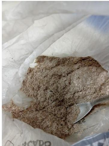
**Figura 2.9 Fibra molida empleando el Molino Planetario de Bolas**
