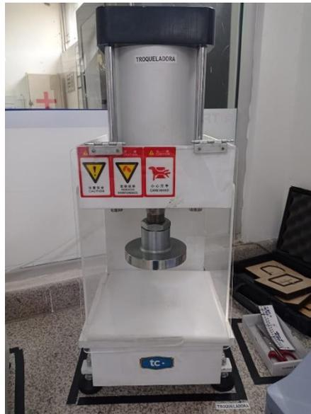
**Figura 2.13 Troqueladora marca Zhongli empleada para la obtención de probetas**
