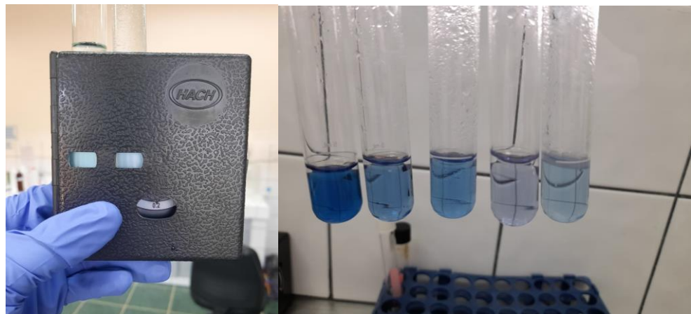
Figura 2.6 Test visual. Disco de color para determinación aproximada de concentración de tensoactivo
