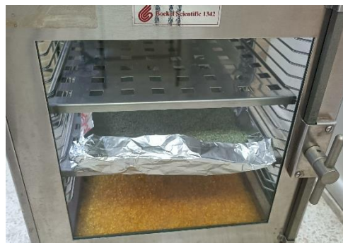
Figura 4.2. Pre-tratamiento a la zeolita y carbón activado en el Laboratorio de Analítica, FCNM.
