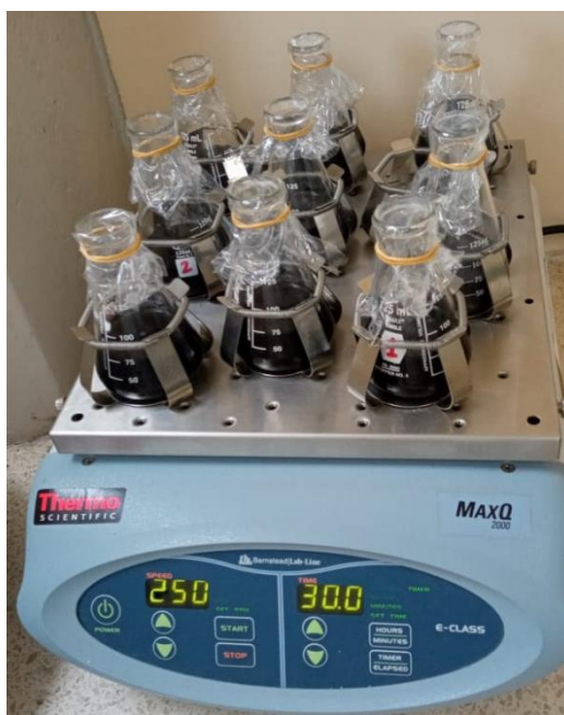
Figura 2.4 Sistema de agitación para el estudio batch en el Laboratorio de Analítica, FCNM.
