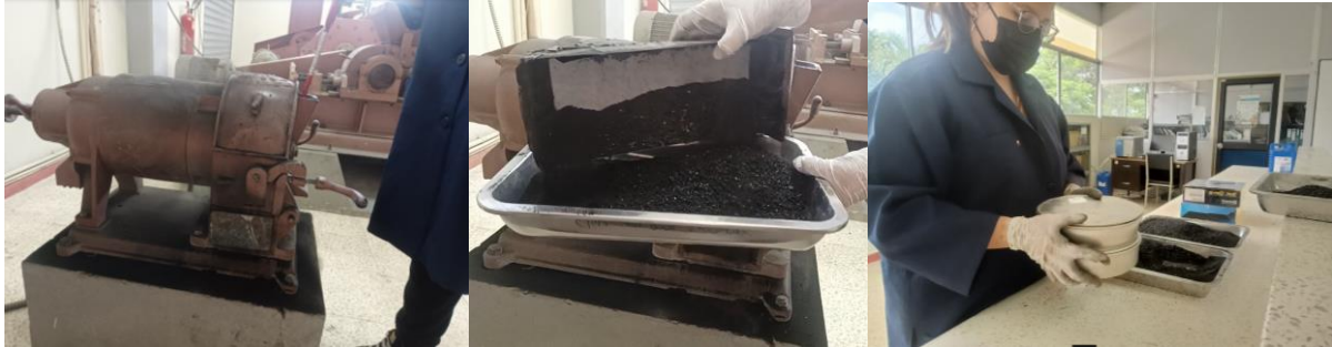
Figura 4.1. Trituración y tamizado del carbón activado en el laboratorio de mineralogía, FICT.
