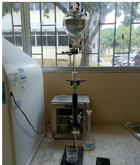
Figura 2.6 Sistema de filtración de estudio continuo en Laboratorio de Analítica, FCNM.
