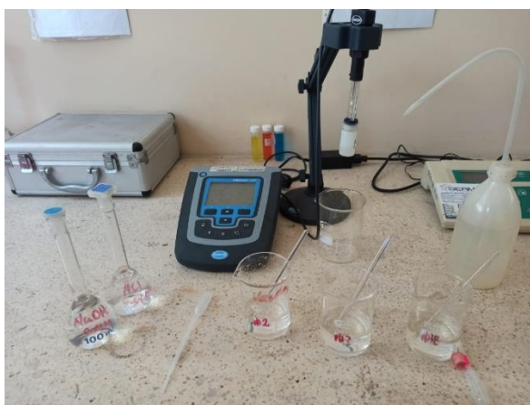
Figura 2.5 Sistema de variación de pH en Laboratorio de Analítica, FCNM.
