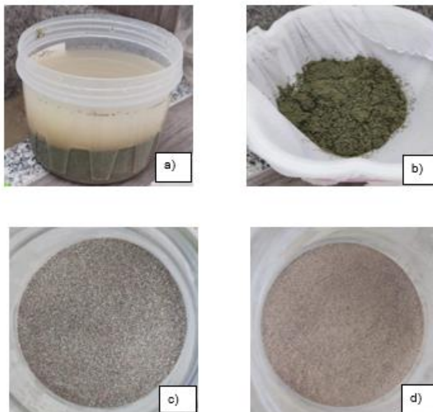
Figura 9. Proceso de secado de Zeolita
