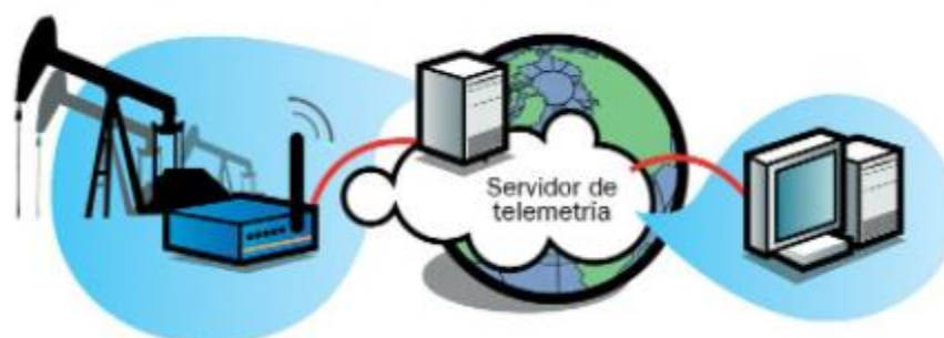
Ilustración 2.1 Esquema de comunicación de telemetría [31]
