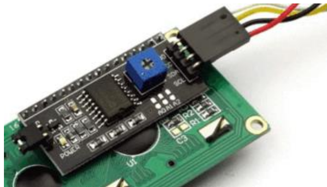
Ilustración 2.8. Módulo I2C acoplado a pantalla LCD. [58]
