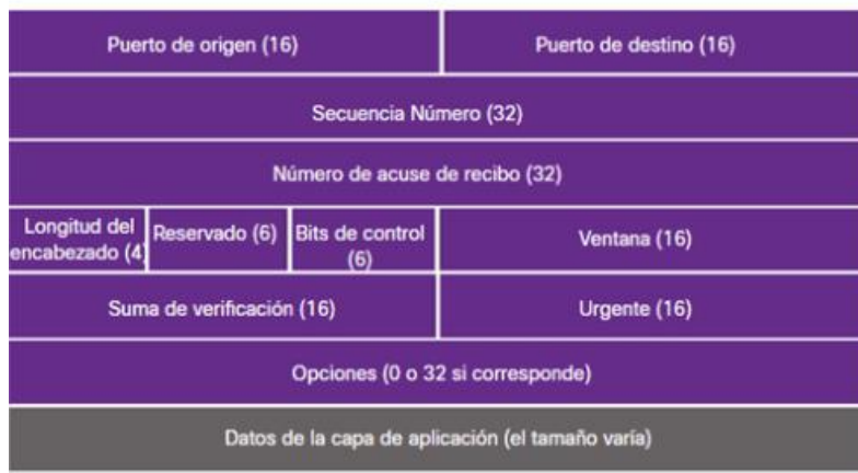
Ilustración 2.9 Encabezado del protocolo TCP [60]
