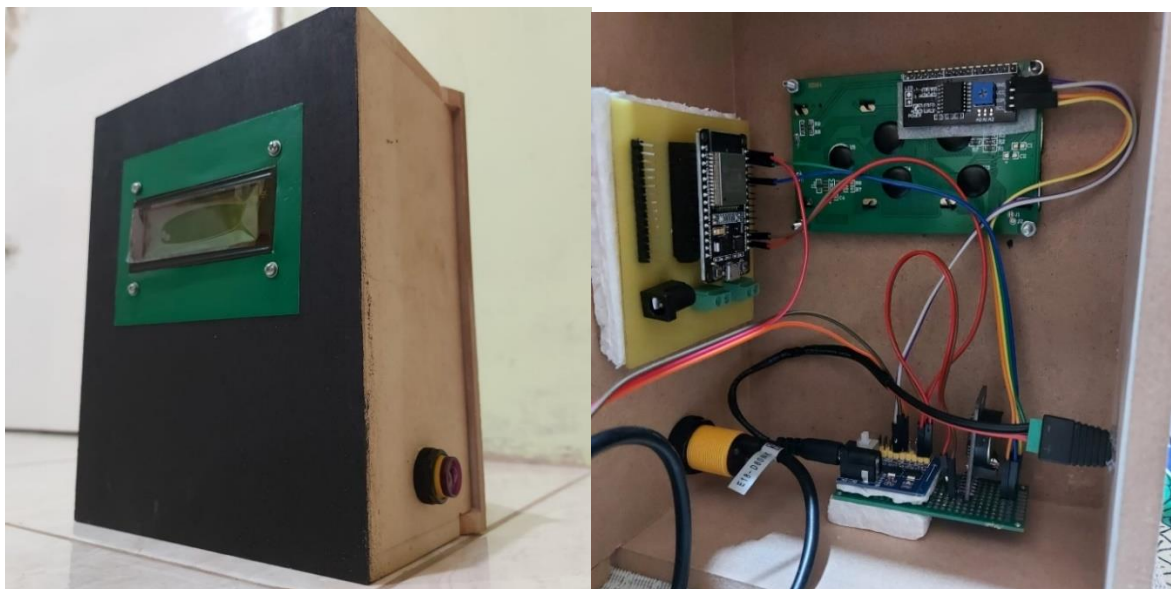
Ilustración 3.33 Construcción de prototipo de conteo de usuarios
