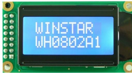
Ilustración 2.7. Pantalla LCD 8x2. [56]
