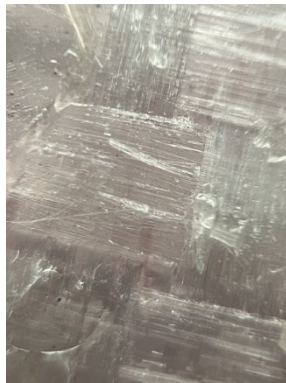
Figura F.4. Delaminación del espécimen para 90% HR.
