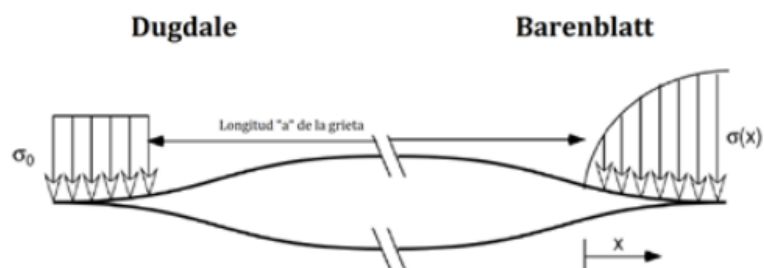
Figura 1.3 Distribución de la tensión en el origen de fisura
