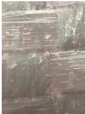
Figura F.2. Delaminación del espécimen para 78% HR.
