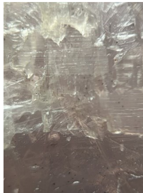
Figura F.2. Delaminación del espécimen para 78% HR.
