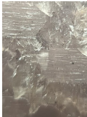
Figura F.4. Delaminación del espécimen para 90% HR.
