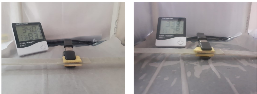
Figura 2.15 Curado de la resina dentro del invernadero a diferentes humedades
