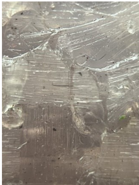
Figura F.3. Delaminación del espécimen para 82% HR. a) 0.25 días curado; b) 2 días curador; c) 5 días curado; d) 7 días curado
