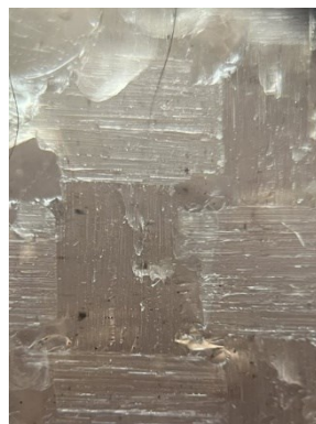
Figura F.1. Delaminación del espécimen para 66% HR.
