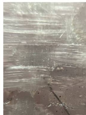
Figura F.1. Delaminación del espécimen para 66% HR.
