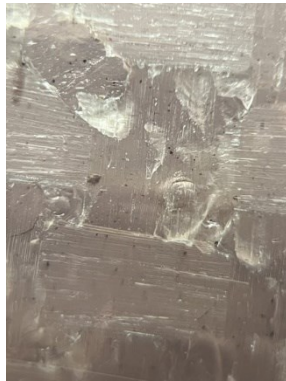
Figura F.3. Delaminación del espécimen para 82% HR. a) 0.25 días curado; b) 2 días curador; c) 5 días curado; d) 7 días curado
