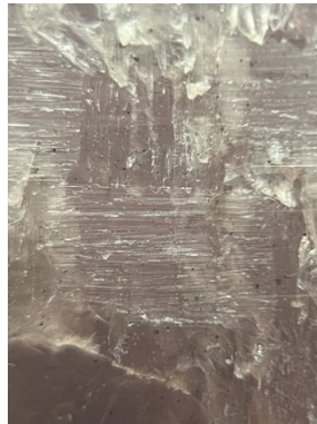
Figura F.3. Delaminación del espécimen para 82% HR. a) 0.25 días curado; b) 2 días curador; c) 5 días curado; d) 7 días curado
