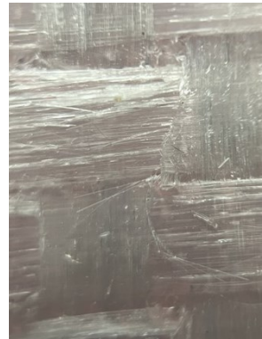
Figura F.3. Delaminación del espécimen para 82% HR. a) 0.25 días curado; b) 2 días curador; c) 5 días curado; d) 7 días curado
