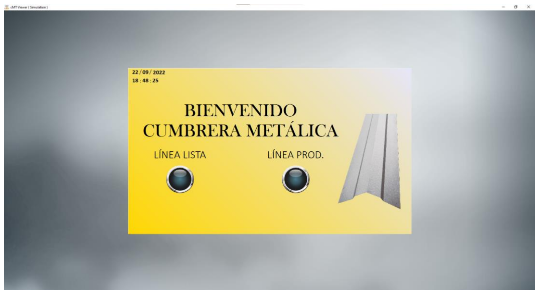
Imagen 72 Uso de cMT Viewer para la visualización de la interfaz de usuario [Autoría propia]
