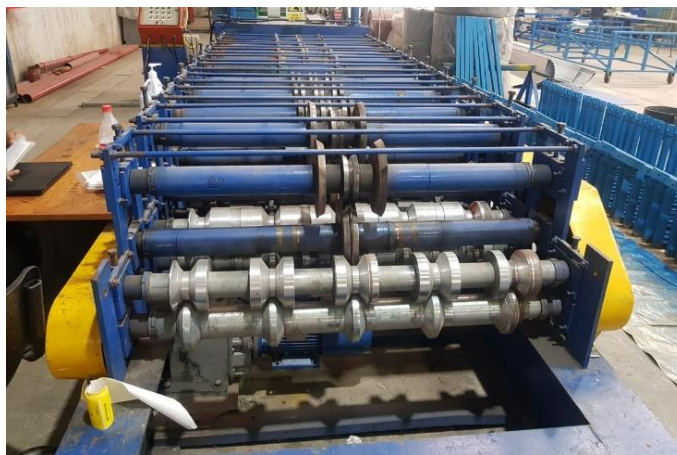
Imagen 54 Sistema de rodillos formadores [Autoría propia]
