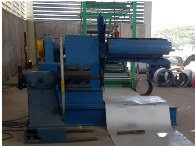
Imagen 50 Sistema del desbobinador [Autoría propia]
