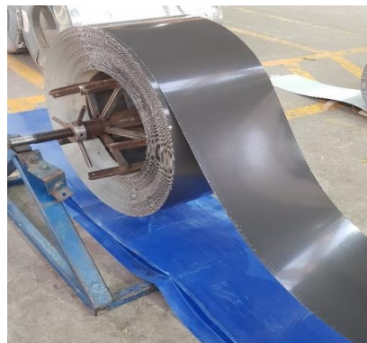
Imagen 1 Bobina de zinc [Autoría propia]
