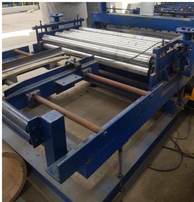
Imagen 52 Sistema de rodillos de entrada [Autoría propia]
