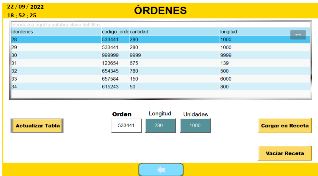
Imagen 65 Interfaz de usuario para la vinculación de órdenes con la base de datos [Autoría propia]
