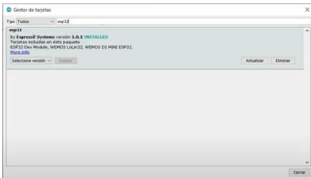
Fig. 23. Instalando placa de Esp32 en el sketch de Arduino.
