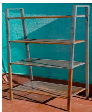
Fig. 13. Infraestructura de hierro donde la presencia de óxido es evidente. [57]
