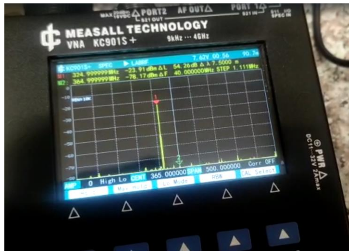
Figura 44 Dispositivo de medición RF
