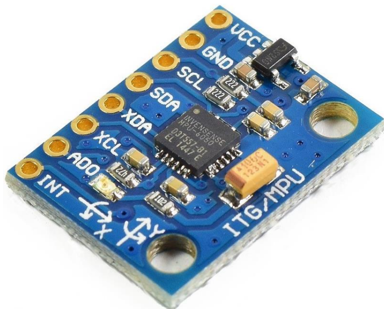
Figura 1.2.Sensor MPU6050. Fuente: (Naylamp Mechatronics SAC, 2021)
