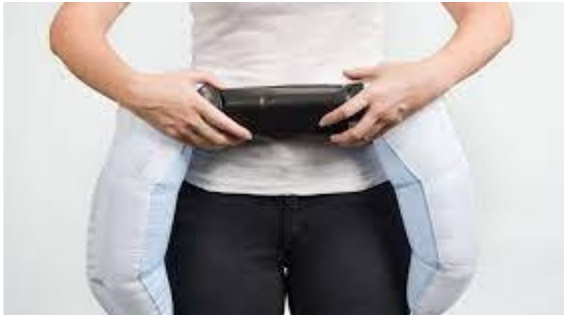
Figura 2.3. Bolsas de aire en funcionamiento. Fuente: (Tamura, Yoshimura, Sekine, Uchida, & Tanaka, 2009)
