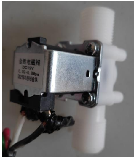
Figura 1.9. Electroválvula Neumática. Fuente: (Autores, 2022)
