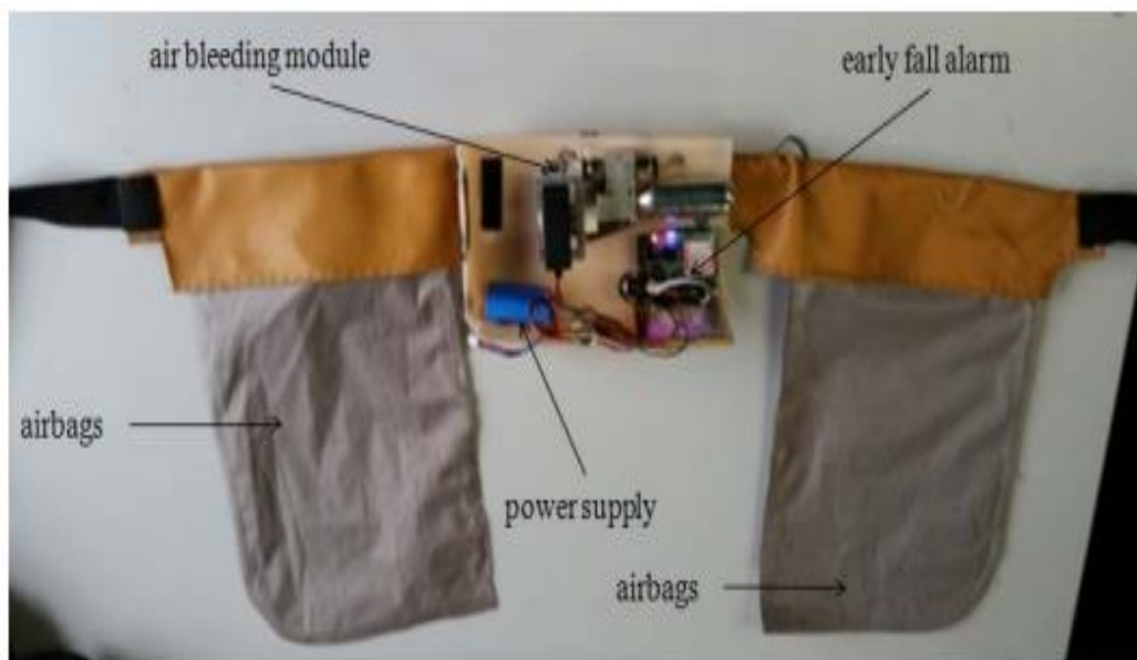
Figura 1.15. Prototipo del cinturón de protección y alerta de caídas (Yao, y otros, 2015)
