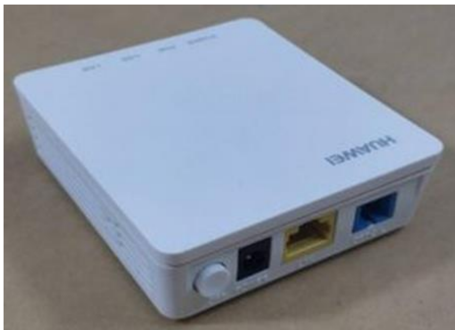
Figura 3.5 - ONT (Optical Node Terminal) HG8310 Fuente: Autores
