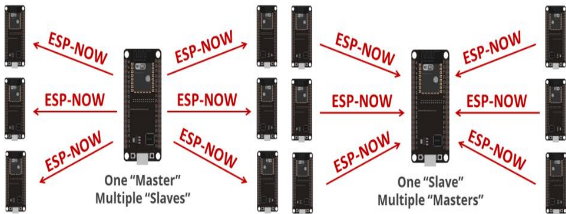
Figura 1.12 Comunicación unidireccional un Maestro-varios Esclavos (izquierda) y un Esclavo-varios Maestros (derecha) [30].
