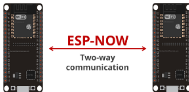
Figura 2.15 Comunicación Bidireccional entre dispositivos ESP32 [30]
