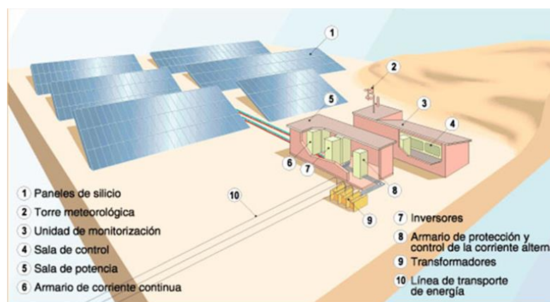
Figura 1.3 Esquema de Parque Solar [16].
