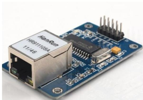
**Figura 1.8 Presentación física del módulo Ethernet ECN28J60 [8].**
