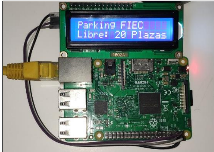
Figura 4.3. Pantalla LCD conectado a raspberry pi mediante el protocolo I2C.
