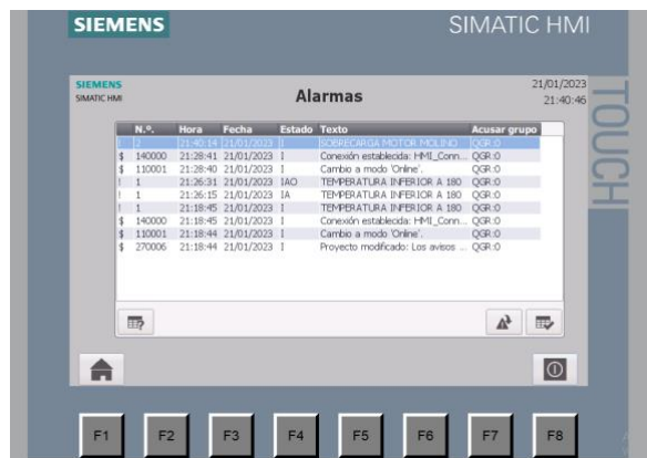
Figura 3.20 Alarma que registra la interacción del operador frente al fallo avisado
