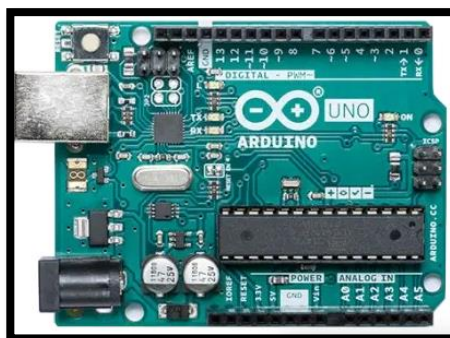
Ilustración 2.8. Tarjeta de desarrollo Arduino UNO [45]
