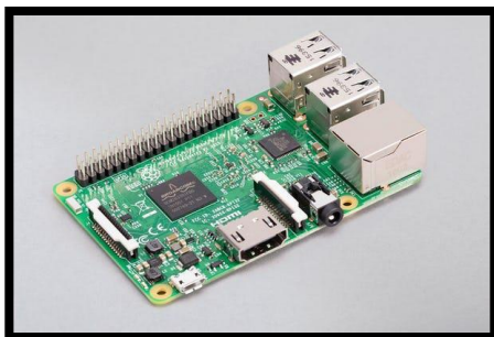
Ilustración 2.13. Tarjeta de desarrollo Raspberry Pi 3 Modelo B [51]
