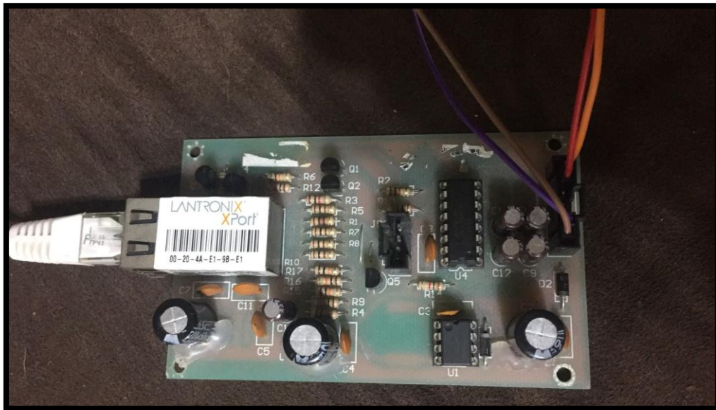
Figura 4.4 Módulo LANTRONIX conectado a la red
