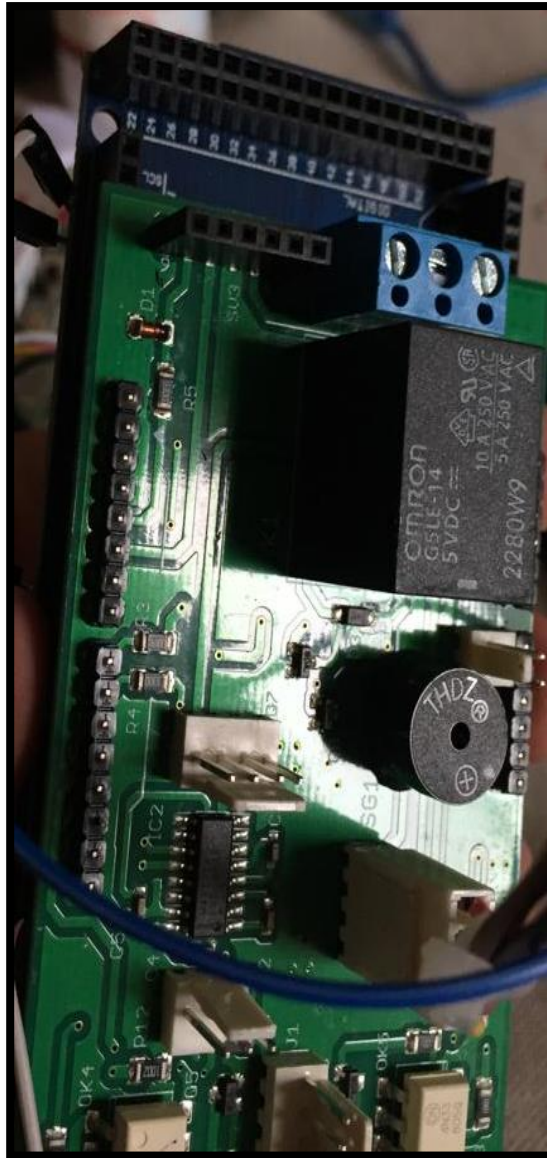
Figura 7.2 Arduino con la placa io2 conectada
