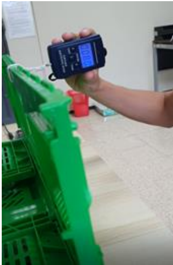
Figura 2.3 Mediciones de fuerza para levantar las caras de la gaveta
