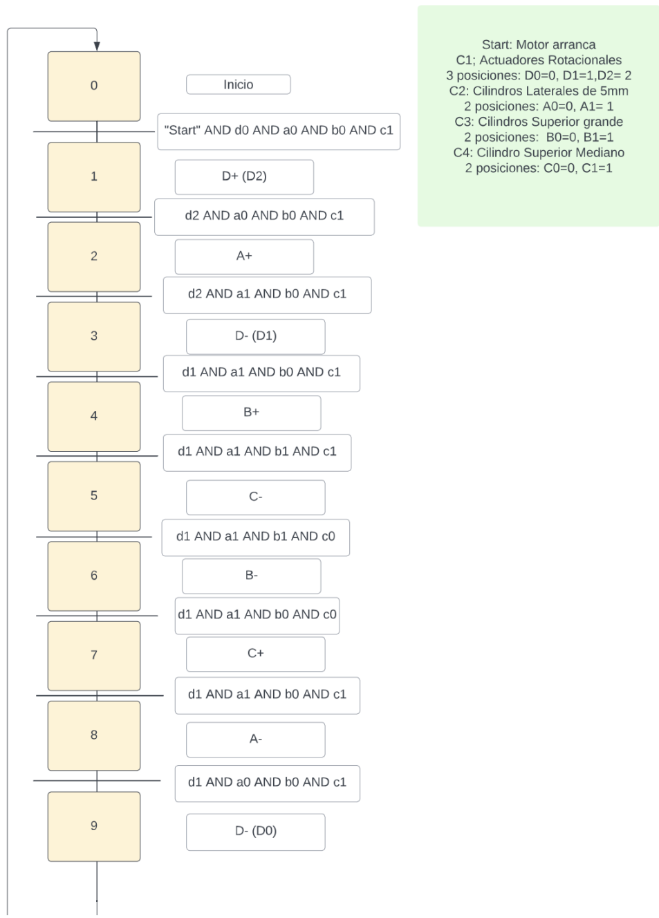
Figura 3.5 Orden de activación de cilindros
