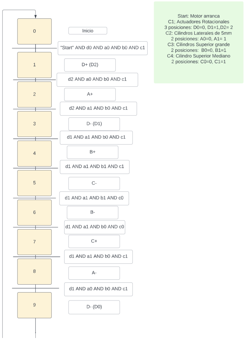
Figura E.2 Diagrama de Fases y Estado con las etapas respectivas
