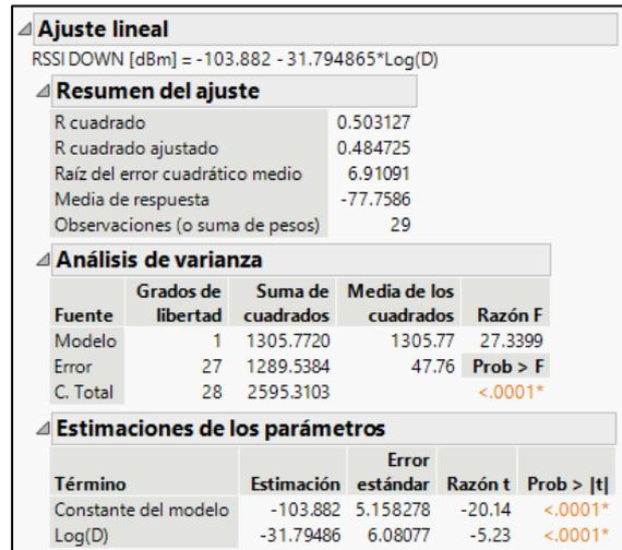
**Figura 3.52 – Correlación de RSSI DOWN y logaritmo de la distancia – Modelo empírico**
