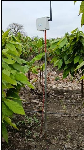
**Figura 3.66 – Sensor de humedad colocado a 50cm de una planta de cacao**
