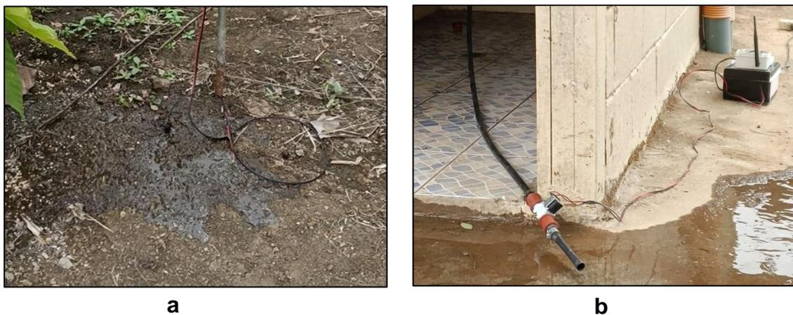
**Figura 3.68 – Electroválvula activada con suelo con demasiada humedad**
