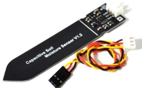
Figura 2.31 Sensor de Humedad Capacitivo
