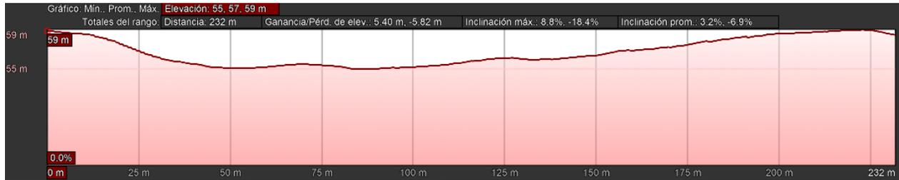
**Figura 2.18 – Perfil de nivelación del Rayo B**
