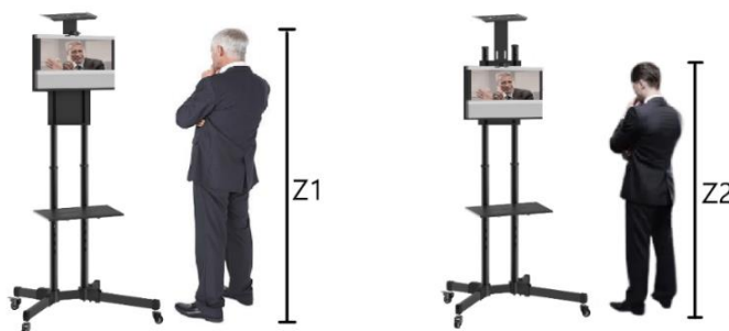
Figura 2.2 Diseño conceptual del tele robot con diferentes estaturas de usuarios
