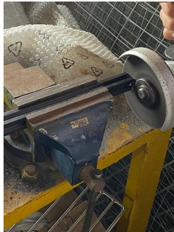
Figura I.9 Proceso de corte con amoladora
