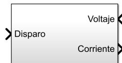
Figura 3.3: Modelo del arco eléctrico ubicado en cada polo del CB.
