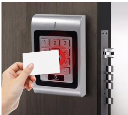
Figura 1.8 Dispositivo de control de acceso mediante lector RFID y clave
