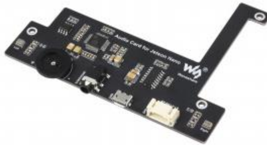
Figura 2.12 Tarjeta de audio Waveshare para Jetson Nano [38]
