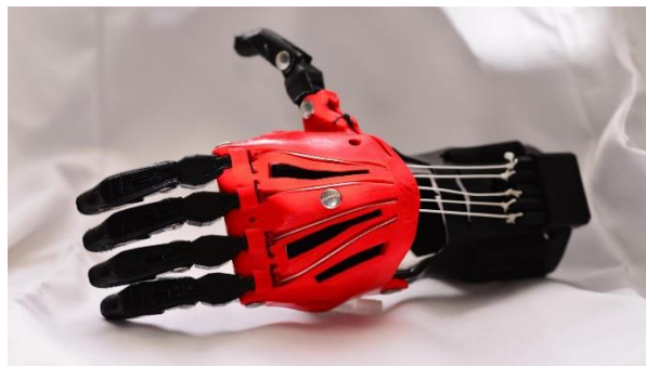
Figura 1.1 Prótesis manufacturada por impresión 3D [14]
