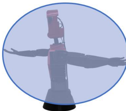
Figura 3.11 Vista lateral del espacio de trabajo del robot
