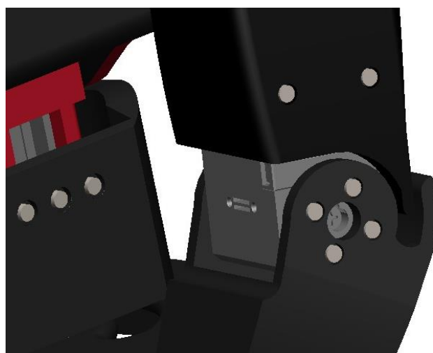
Figura 3.3 Sujeción de motor fijo respecto a pieza
