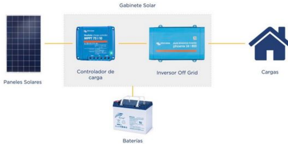
Figura 2.21: Sistema fotovoltaico aislado de la red.
