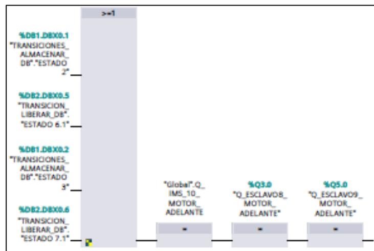
Fig. A1- 2 Segmento 2: Motor Encendido Hacia Adelante
