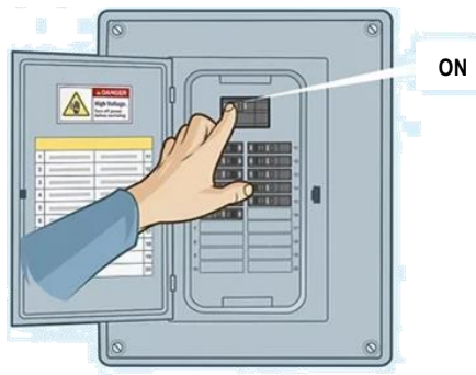
Figura A6. Verificación de estado del disyuntor principal.
