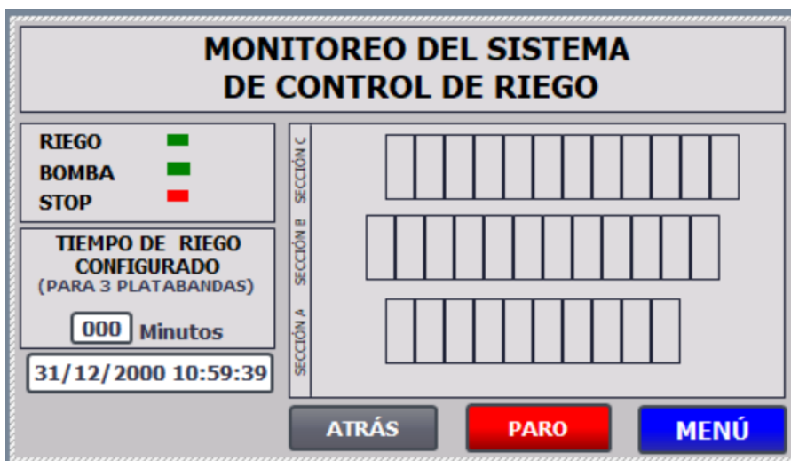
Figura 3.19 Pantalla de monitoreo de sistema de control de riego.
