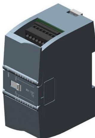
Figura 2.22 Módulo de entrada analógica para sensores tipo Termocupla SM1231 – 6ES7231-5QD32-0XB0. [25]
