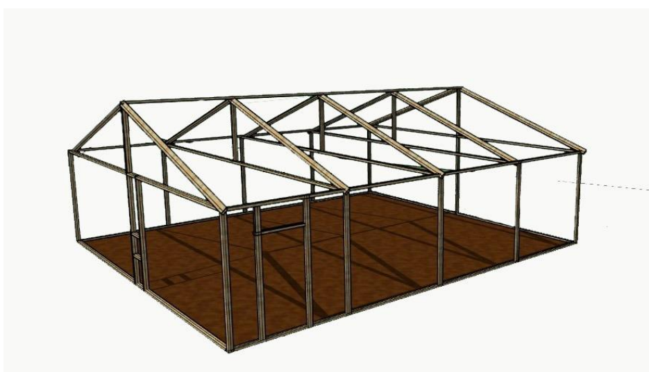
Figura A2. Vista de la estructura del invernadero, compuesta por caña guadua.
