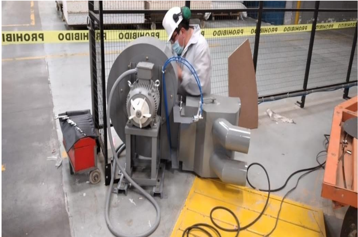
Figura 0.5 Proceso de Balanceo Dinámico. [Abril Pachacama]
