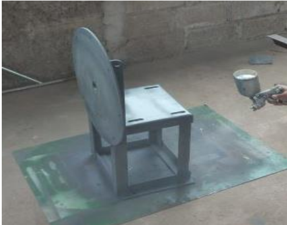
Figura 0.3 Pintado de Mesa del Motor. [Abril Pachacama]
