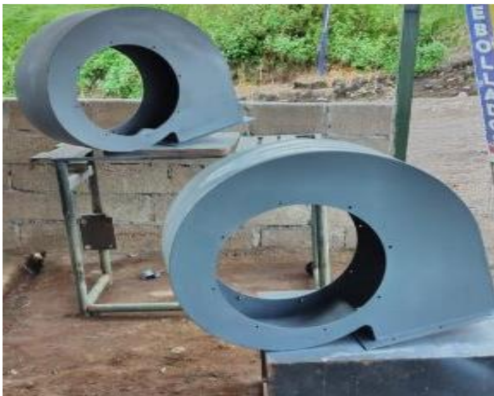
Figura 0.4 Carcasa de Ventilador. [Abril Pachacama]
