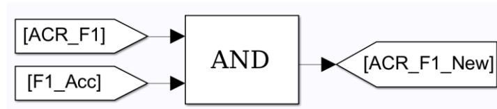
Figura 3.26 Lógica de accionamiento del feeder 1.
