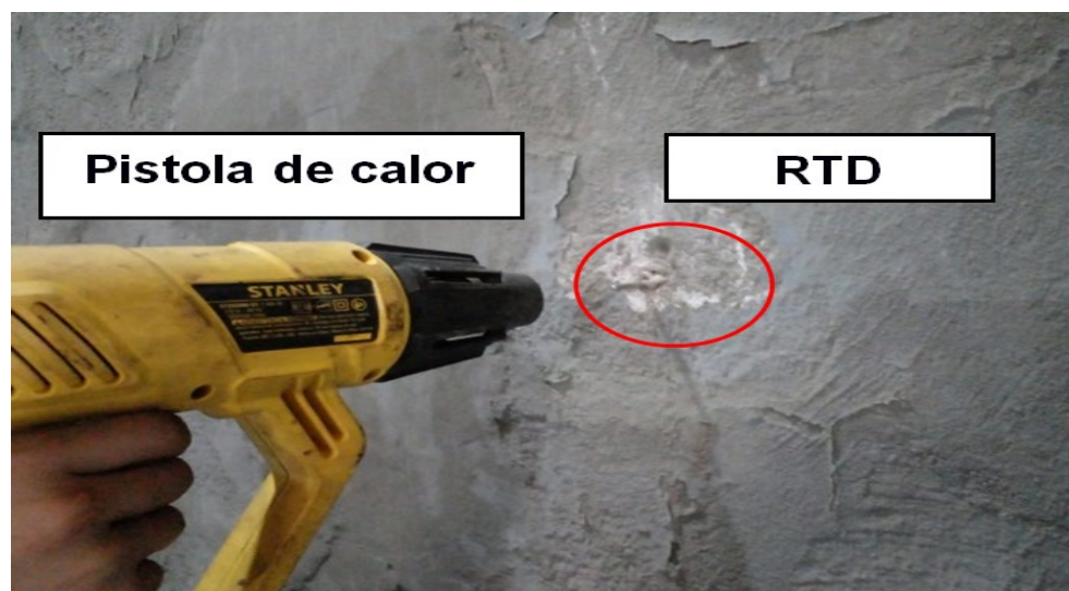
Figura 3.13 Prueba para aumentar la temperatura del RTD
