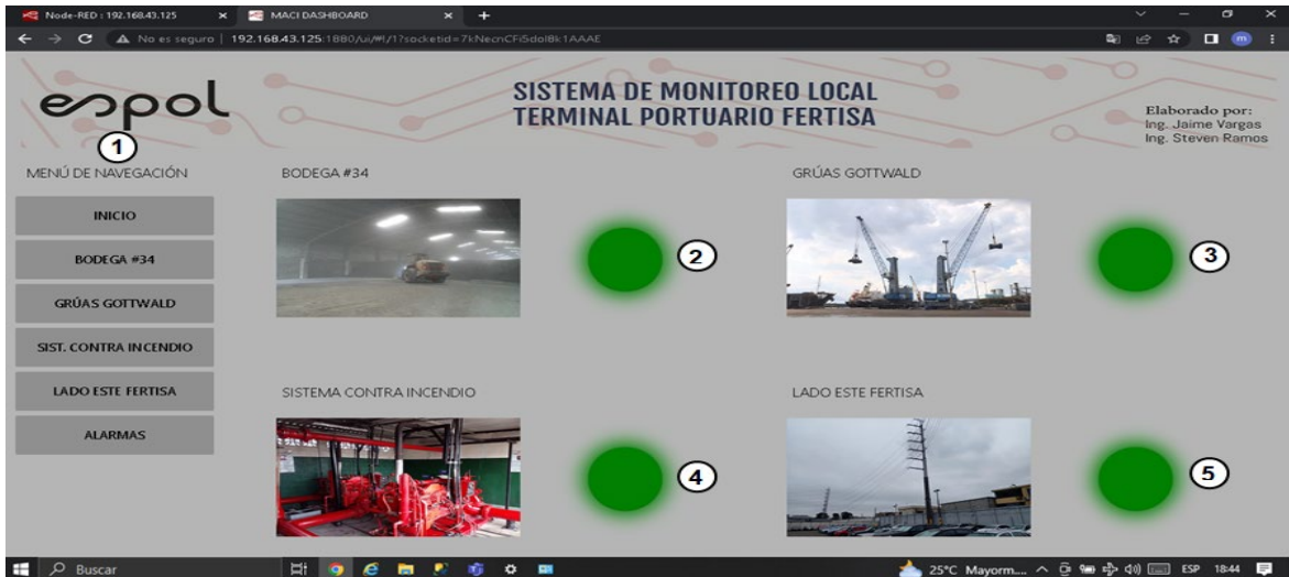
Figura 3.1 Pantalla “Inicio” del SCADA local en Node-RED
