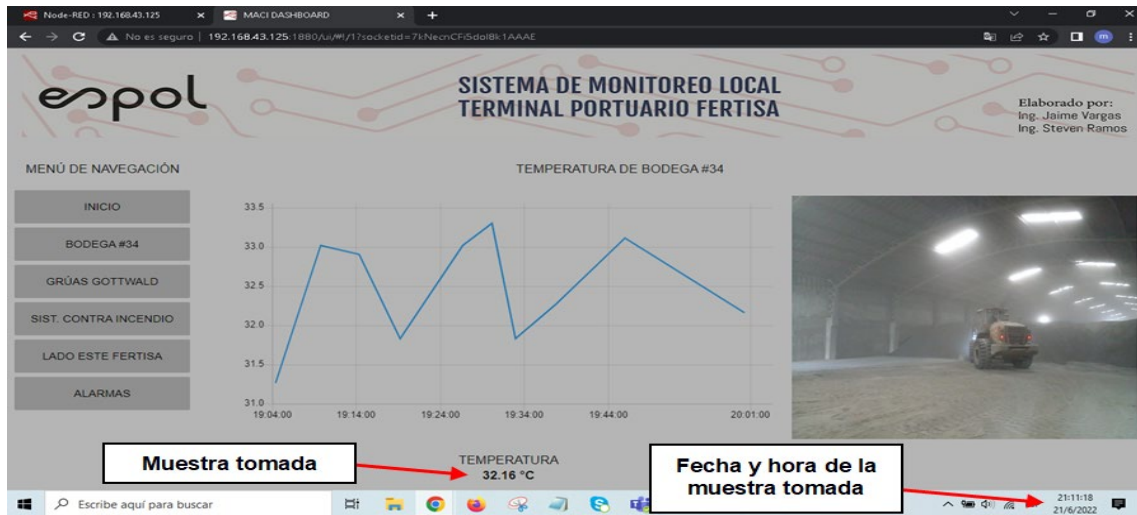
Figura 3.11 Captura de pantalla del SCADA local en Node-RED
