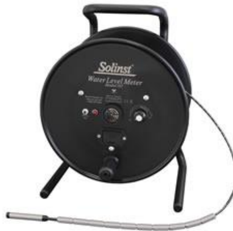
Figura 3.8 Medidor de nivel de agua marca Solinst, utilizado para el registro de niveles piezométricos.
