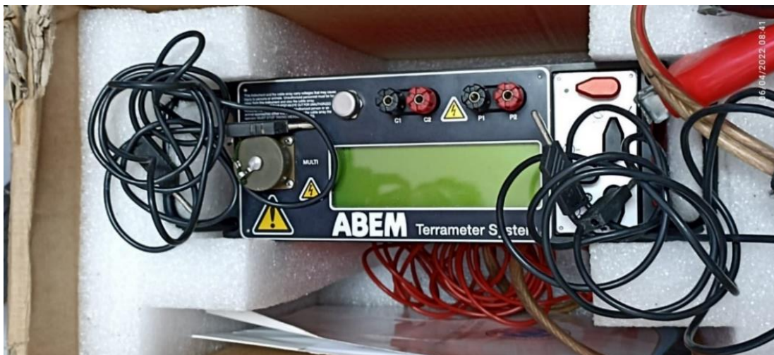
Figura 3.6 Equipo Terrameter SAS 1000 utilizado para la obtención de datos de TGEs y SEVs.
