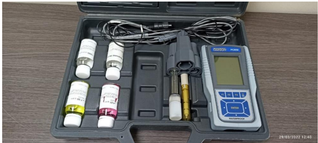
Figura 3.7 Equipo multiparamétrico marca OKTAON para medición de parámetros fisicoquímicos.
