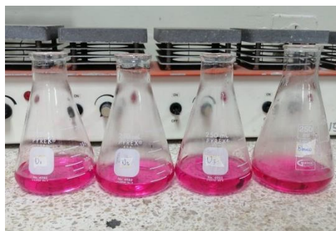
Figura 26. Solución receptora de ácido bórico con indicador
