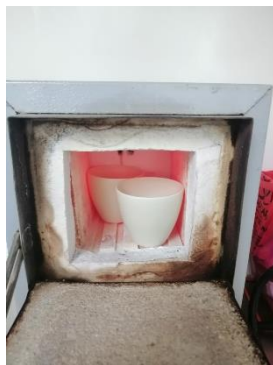
Figura 17. Calcinación de la muestra en mufla a 750°C
