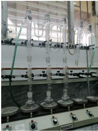
Figura 21. Sistema Soxhlet para determinación de grasas.
