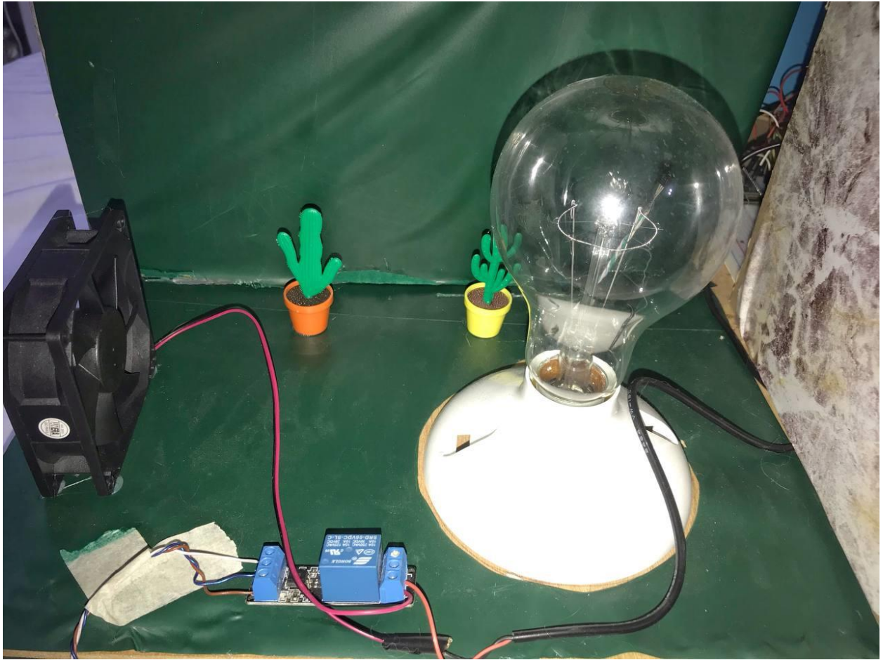
Figura F.3 Infraestructura del escenario de control de temperatura PID
