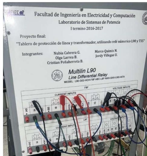
Figura 3.2 Conexión física del Relé GE Multilin L90
