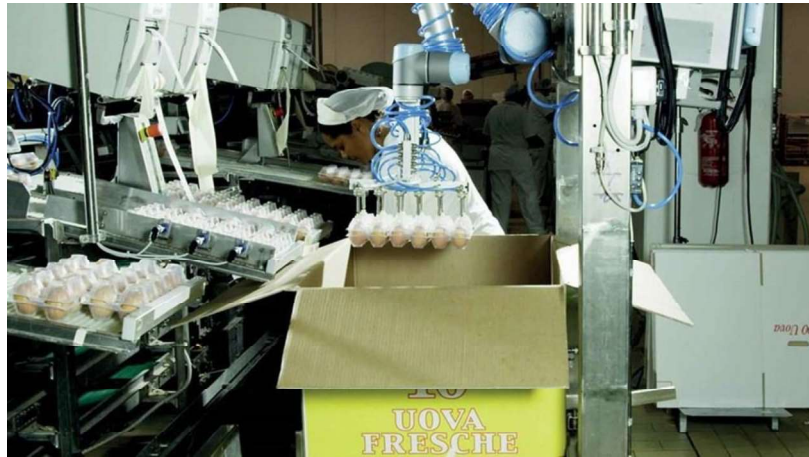
Figura 3.14 Proceso de empaquetado de Huevos usando un robot industrial.
