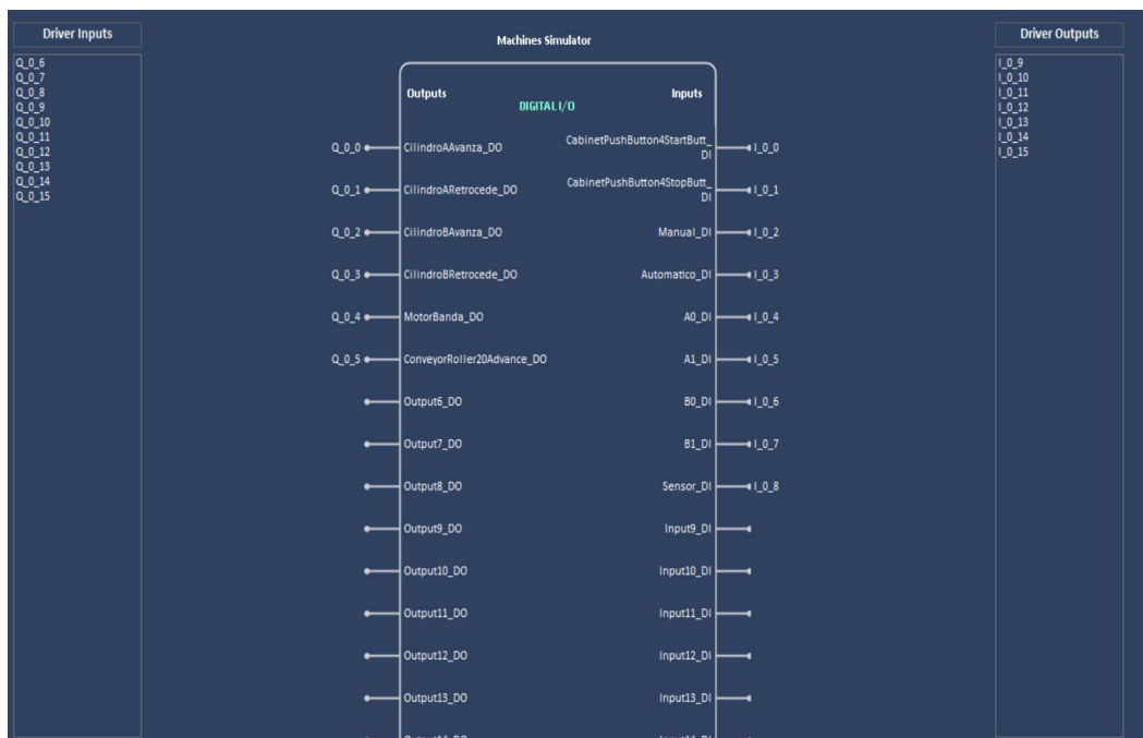
Figura 3.6 Variables correspondientes al PLC Siemens en EasyPLC
