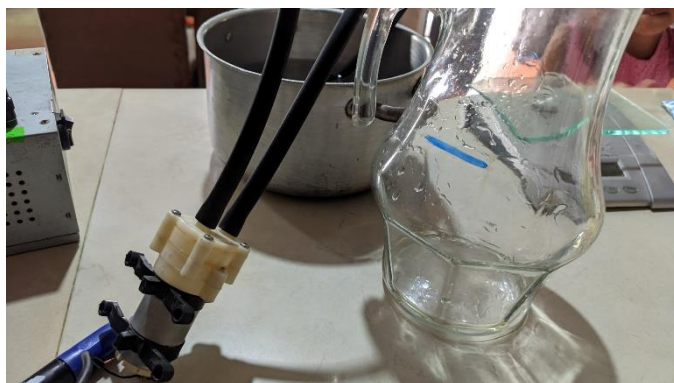
Figura 2.16 Prueba de variación de flujo de la bomba de recirculación.
