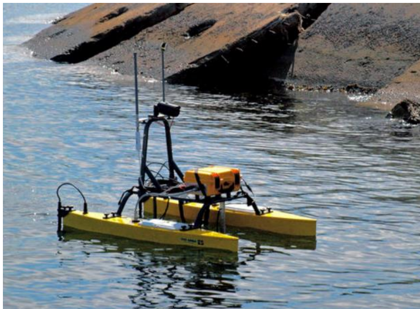
Figura 1.3 Vehículo autónomo, de Subsea Tech, para encuestas oceánicas, hidrográficas y mediciones ambientales [9]
