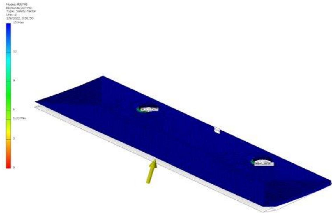
Figura L.9 Simulación acerca del factor de seguridad que nos brinda la cuchilla de corte [Autores].
