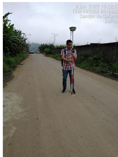
Ilustración 12. Toma de puntos para obtención de geometría de la Calle Celestino Sosa
