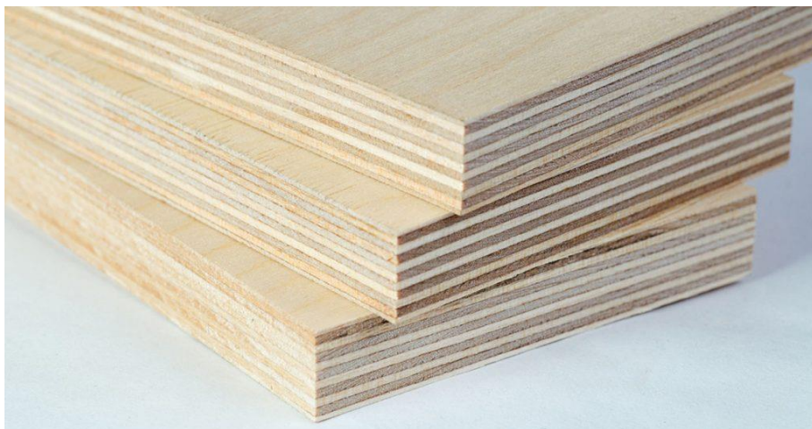
Figura 15. Tablero de contrachapado
