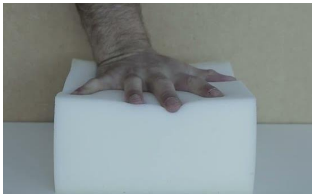
Figura 20. Espuma de densidad de 35 kg/m 3
