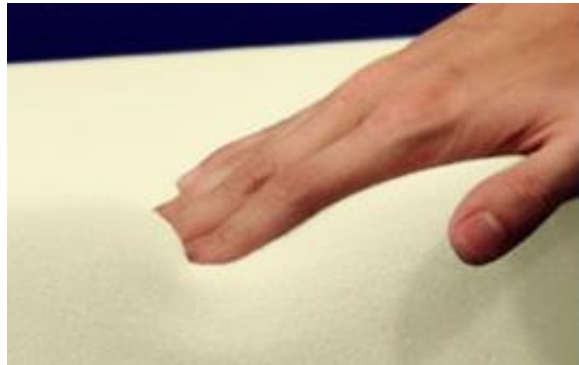
Figura 19. Espuma de densidad de 30 kg/m 3
