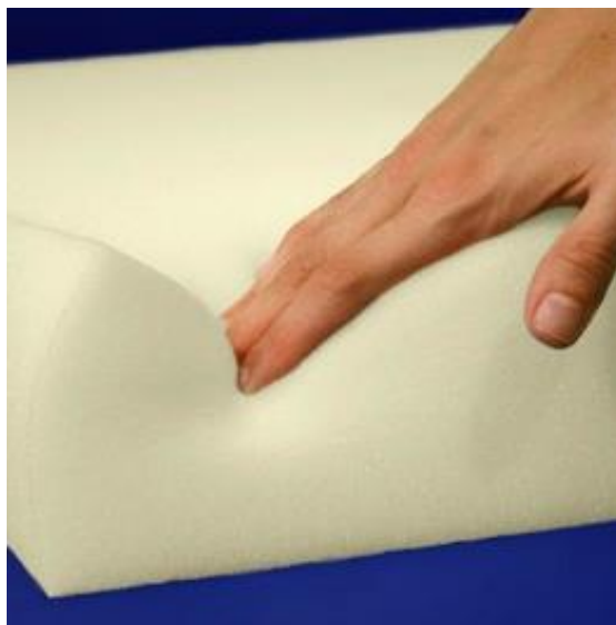
Figura 18. Espuma de densidad de 25 kg/m 3
