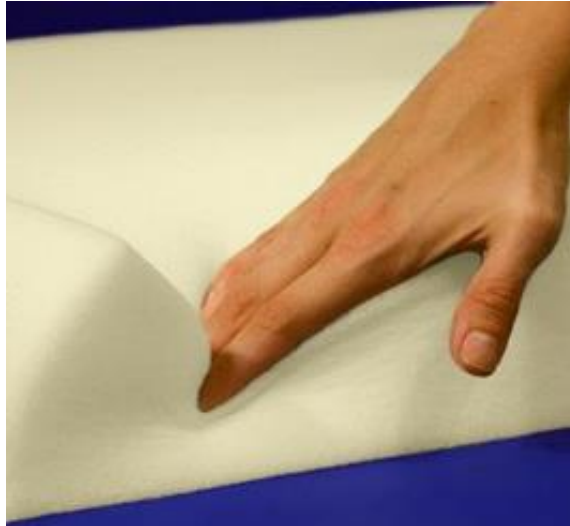
Figura 17. Espuma de densidad de 20 kg/m 3 .
