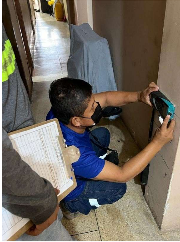
Figura 3.5 Ensayo con el pachómetro en la vivienda
