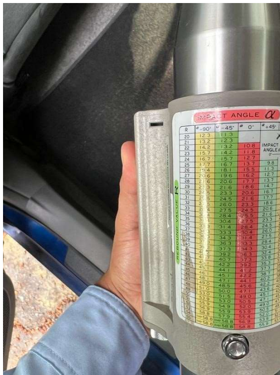
Figura 3.2 Tabla para determinar el f_c con ayuda de un factor R del esclerómetro Fuente: Fernández, Hermenegildo 2022.
