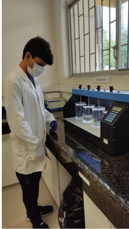
Ilustración 14 Ensayo de test de jarras 2
