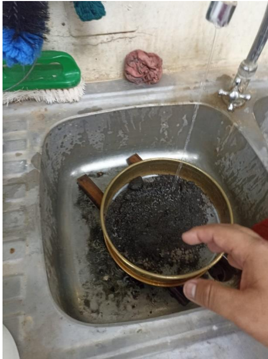
Figura 3.8 Lavado de material con tamiz 200.
