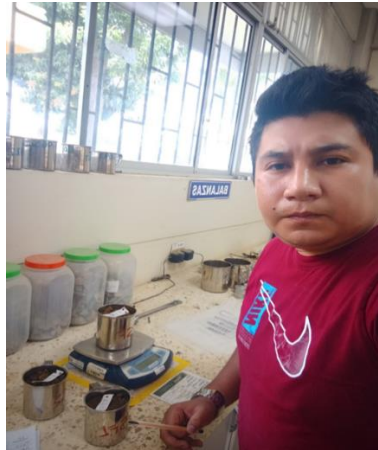
Figura 3.7 Toma de peso de la muestra seca
