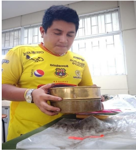
Figura 3.9 Lavado del material sobre el tamiz 40
