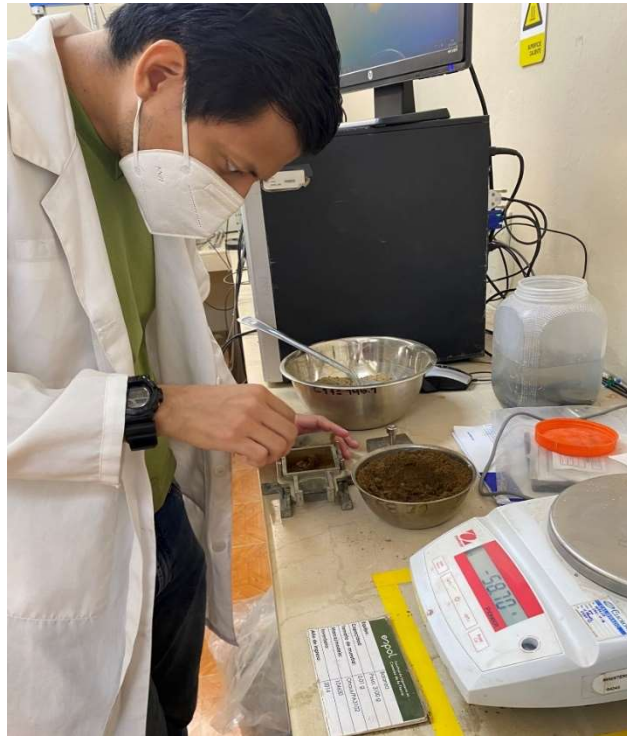
Figura 2.13: Compactación de las 3 capas de muestra
