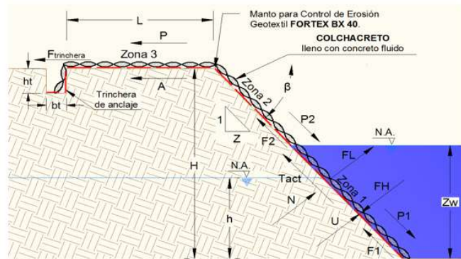
Figura 2 Sección transversal a proteger
