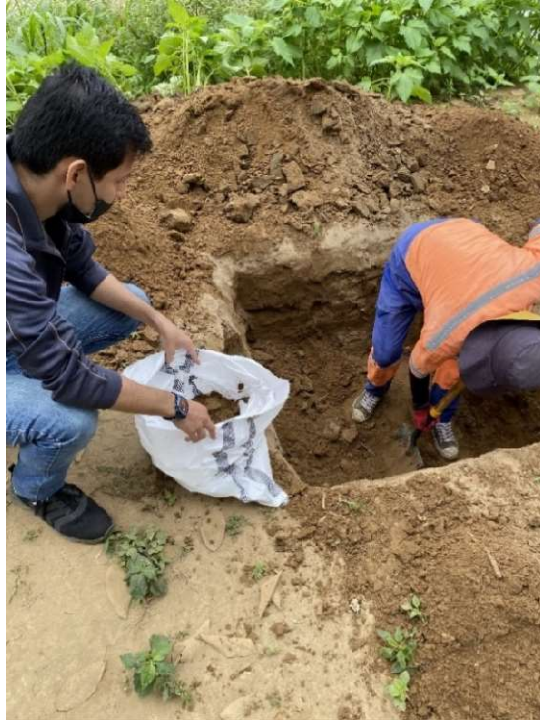
Figura 2.7: Calicatas, borde del río Catarama
