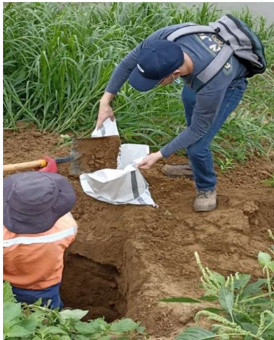
Figura 2.8: Calicatas, borde del río Catarama
