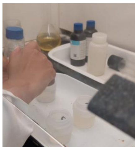
Figura 2.19 Acidificación de la muestra de agua, para su posterior análisis de DQO.
